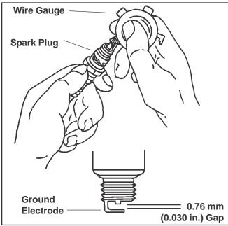
Figure 23. Servicing Spark Plug.
